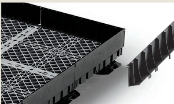
La paratia ad aggancio rapido Greenlift è un elemento che viene installato con un aggancio rapido alla Griglia Plus senza la necessità di utilizzare strumenti specifici. Consente di contenere lateralmente il substrato necessario alla creazione di tetti verdi estensivi.
