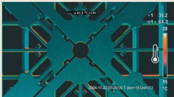
Il sistema di innesto presente nella nuova Griglia Plus, che prevede spazi di tolleranza tra le connessioni maschio-femmina, gestisce autonomamente le possibili dilatazioni termiche generate dalle variazioni di temperatura stagionali, prevenendo deformazioni strutturali del pavimento posato.
