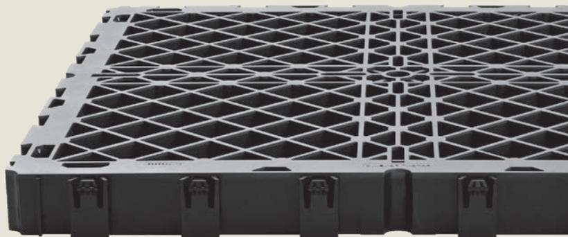
Dall'evoluzione della griglia del sistema GRF nasce la prima griglia di Eterno Ivica con **gomma TPE antiscivolo costampata sulla superficie**. La gomma integrata **riduce lo scivolamento delle lastre** posate, velocizzandone il posizionamento e **minimizzando i movimenti post-posa**.
