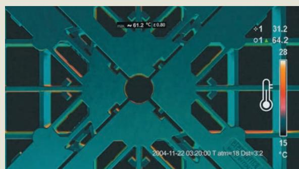
Le système d'emboîtement présent dans la nouvelle Grille Plus, qui prévoit des espaces de tolérance entre les emboîtements mâle-femelle, gère de manière autonome les possibles dilatations thermiques générées par les variations de température saisonnières, prévenant les déformations structurelles du sol posé.
