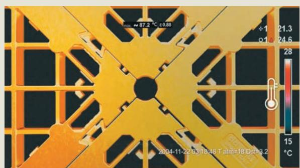
Das Stecksystem des Gitters Plus sieht Toleranzräume zwischen den Steckverbindungen vor. Dadurch gleicht es mögliche Wärmeausdehnungen aufgrund saisonaler Temperaturschwankungen selbstständig aus und verhindert strukturelle Verformungen des verlegten Bodens.
